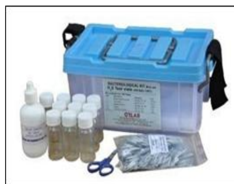
चित्र 5.2: जल गुणवत्ता परीक्षण के लिए फील्ड टेस्ट किट
