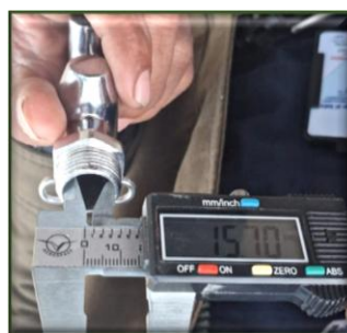
चित्र 3.2: कार्यशील घरेलू नल कनेक्शन में उपयोग हो रहे 15 मिमी नल को दर्शाती तस्वीर
