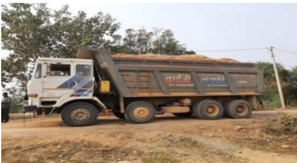
चित्र-4.4 (ख): मानक वहन क्षमता से अधिक ऑव्हरलोडिंग (बिलासपुर जिला, फोटो दिनांक: जनवरी 2021)
