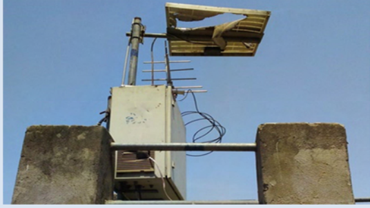
बबलर के लिए सोलर पैनल तथा आरसीसी ब्लॉक क्षतिग्रस्त स्थिति में थे, गंगा में फाफामाऊ, इलाहाबाद
