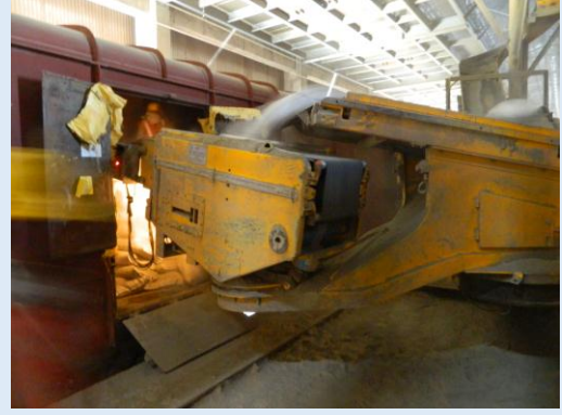
दक्षिण पूर्व मध्य रेल में वैगन में किया जा रहा सीमेंट का यांत्रिक लदान
