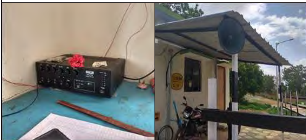
चित्र 2.22: दपूर: हुबली-लोनदा खंड में 529/4 किमी. एलसी गेट स्थान पर मधुमक्खी की आवाज वाले उपकरण की संस्थापना (हनी बी साउंड के बिना)।
